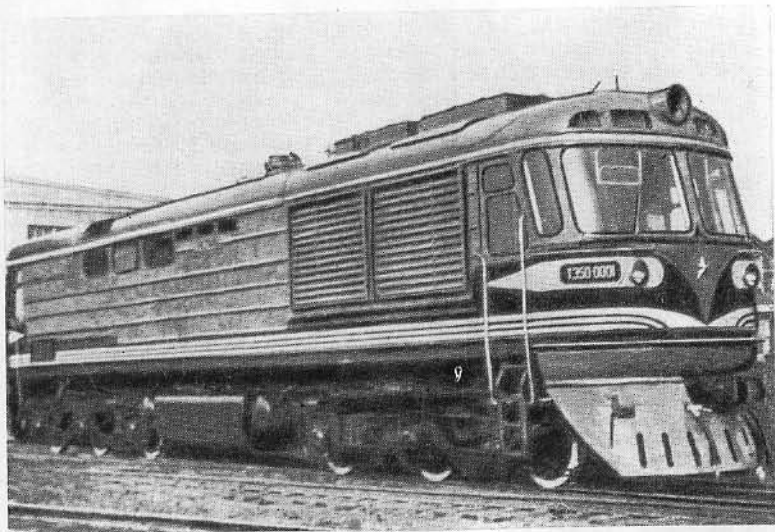
Грузовой тепловоз ТЭ-50. Первый послевоенный тепловоз конструкции коломенского завода.
