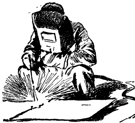
Рабочий сваривает листы металла. Маска защищает сварщика от яркого света и огненных брызг.
