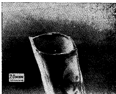
Рис. 8. Микрофотография среза полого волокна из омыленного ацетата целлюлозы, полученная на сканирующем электронном микроскопе
