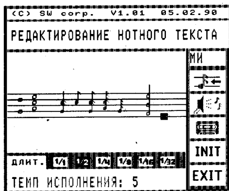
Рис. 4. Вид экрана при работе с программой «KLAWESIN» в режиме редактирования и записи мелодии в ОЗУ
