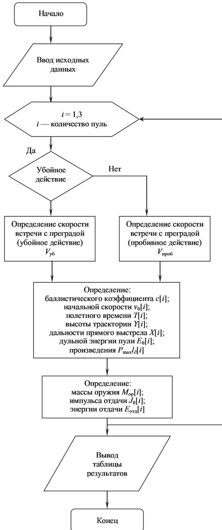
Рис. 2. Алгоритм внешнебаллистического расчета патрона
