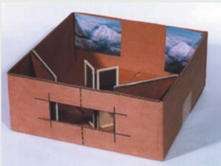
в) самодельный картонный стереоскоп с зеркальной системой
