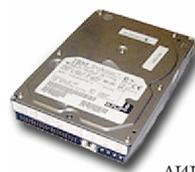
Постоянный магнитный диск компьютера (чаще его называют **винчестер**) скрыт внутри корпуса системного блока.
