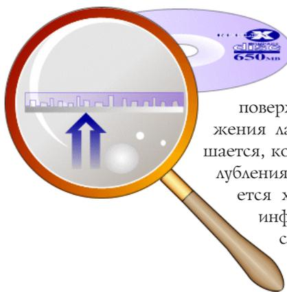
Информация на лазерный диск записывается в виде микроскопических углублений на его поверхности. Яркость отражения лазерного луча уменьшается, когда он попадает в углубления. Таким образом, удается хранить и считывать информацию: углубление соответствует числу 0, а отсутствие углубления — числу 1.
