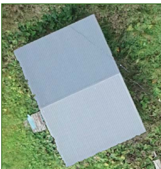
Рис. 5 Пример искажения контура высотного объекта на истинном ортофотоплане
