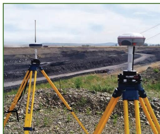
В качестве базового использовался приемник Sokkia GRX3, работа велась в режиме RTK по радио. Приемники в паре «сработались» успешно, соединение было стабильное, заказчик остался доволен полученным результатом.
