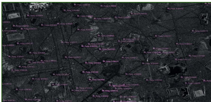
Рис. 2 Пример обнаружения и классификации нефтяных вышек на РЛИ (фрагмент снимка КА TerraSAR-X, Кувейт, Бурганское нефтяное месторождение)
