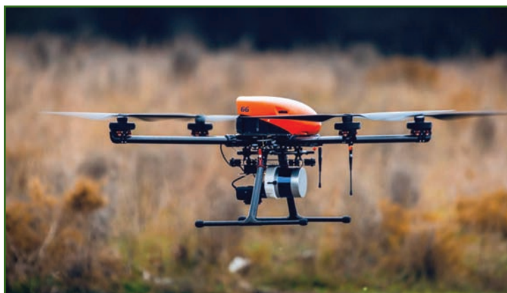
Рис. 1 Общий вид системы «Геоскан 401 Лидар»
