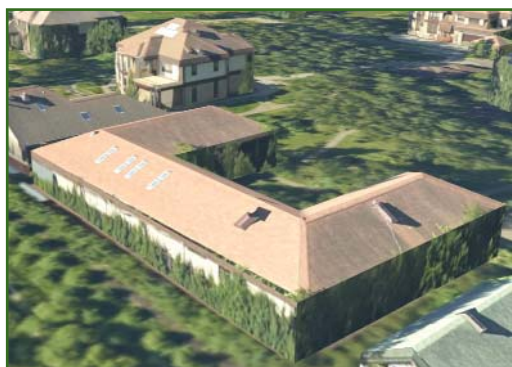
Рис. 4 Результат наложения текстур на реконструированную 3D модель здания
