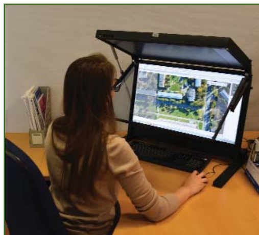
Рис. 6 Процесс измерения координат контрольных точек в стереоскопическом режиме
