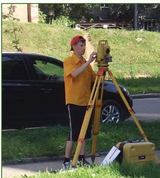
Рис. 4 Выполнение измерений электронным тахеометром
