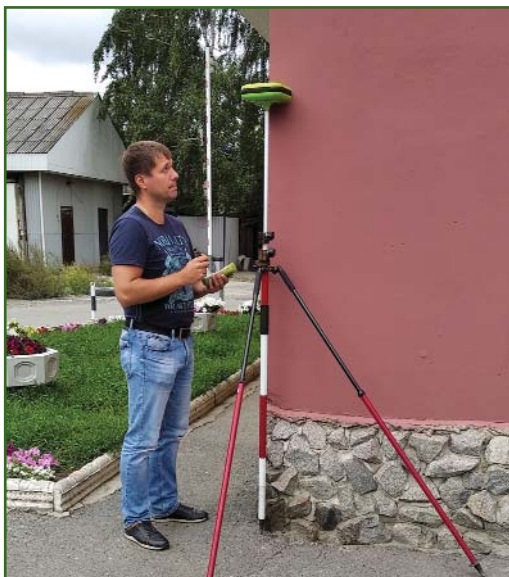
Рис. 3 Выполнение измерений ГНСС-приемником
