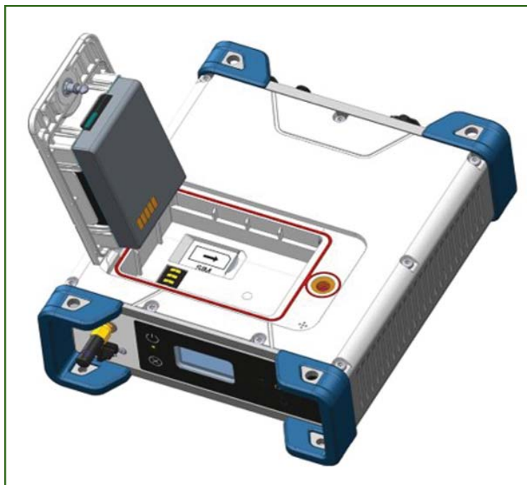
Рис. 3 Замена батареи в ГНСС-приемнике ФАЗА 2
