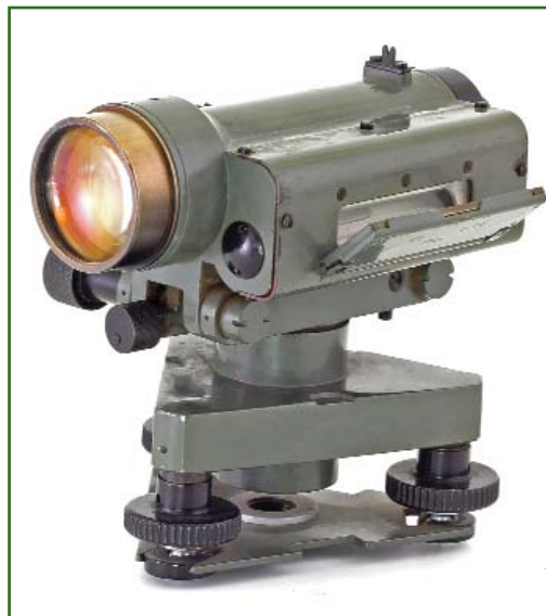
Рис. 25 Нивелир НВ-1. СССР, Изюм, Приборостроительный завод, 1962 г.
