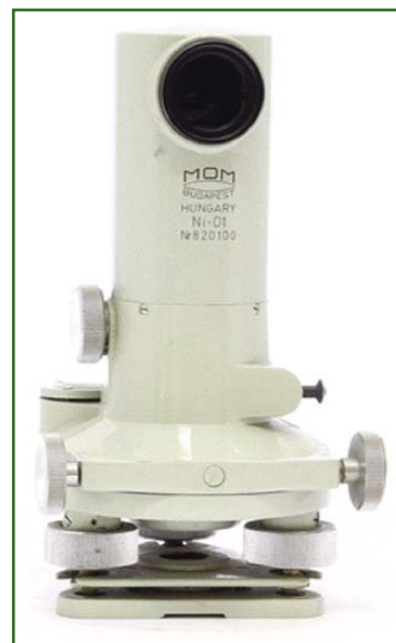
Рис. 29 Нивелир с перископической трубой Ni-D1. Венгрия, Будапешт, MOM (Венгерские оптические заводы), 1960–1970-е гг.
