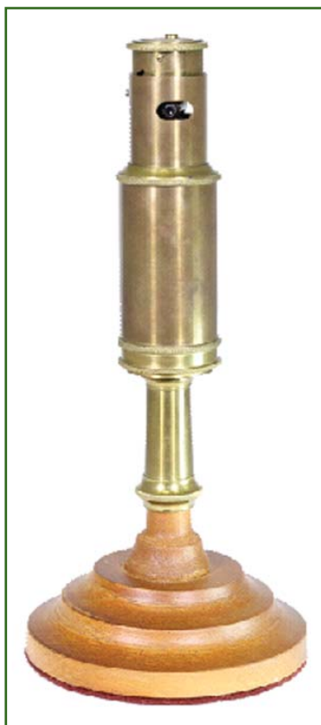
Рис. 27 Нивелир Гулье. Франция, Париж, G.R. Pastourelli, начало XX века
