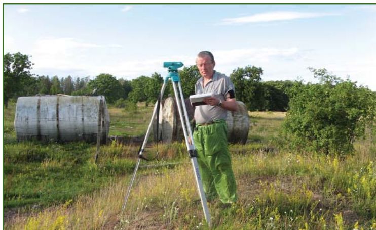
Г.А. Шануров выполняет привязку устройств морского уровня поста на острове Гогланд
