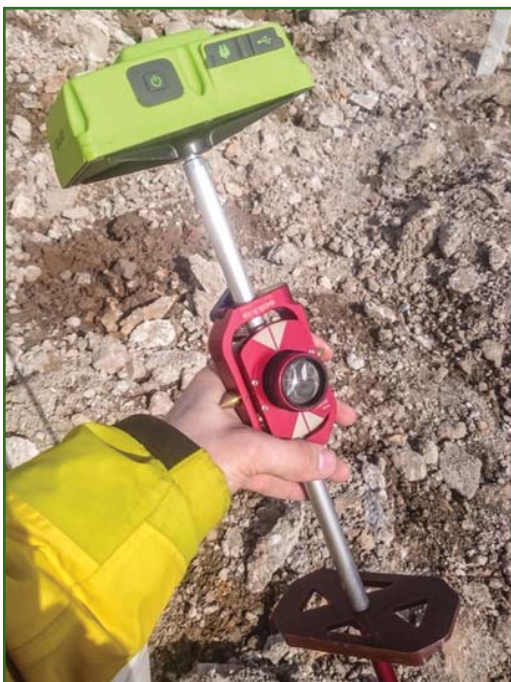
Рис. 6 Приемник TRIUMPH-2 на мини-вехе с отражателем
