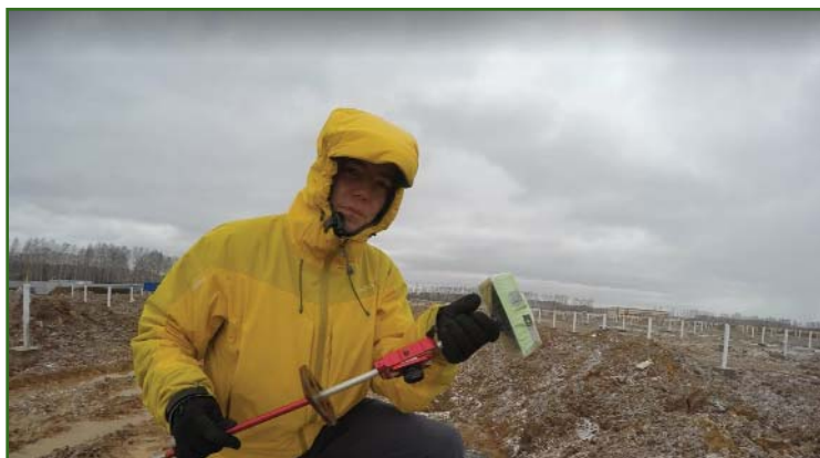
Рис. 2 Автор статьи с приемником JAVAD TRIUMPH-2 на строительной площадке
