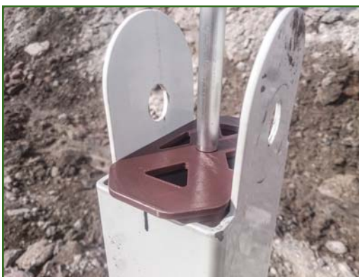
Рис. 5 Опорная площадка для центрирования приемника ГНСС над столбиком
