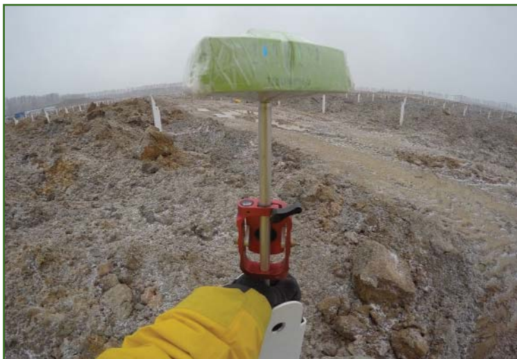
Рис. 7 Измерение координат опорного столбика в режиме RTK
