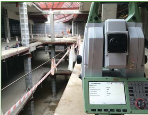
Рис. 3 Процесс сканирования тахеометром Leica Nova MS60
