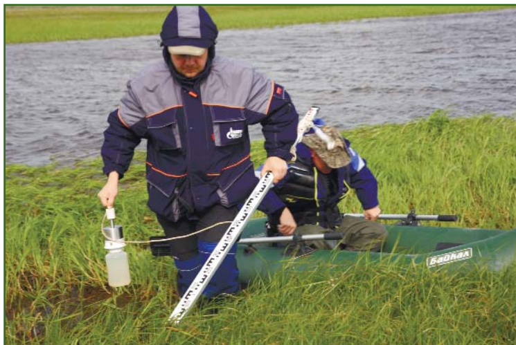
Рис. 4 Исследование водных объектов — отбор пробы на физико-химические показатели (фото Е.Е. Ильяковой, ООО «Газпром ВНИИГАЗ»)
