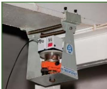
Рис. 5 Датчик углов наклона, закрепленный на балке кровли с помощью специального кронштейна
