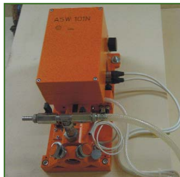
Рис. 6 Датчик подсистемы гидростатического нивелирования
