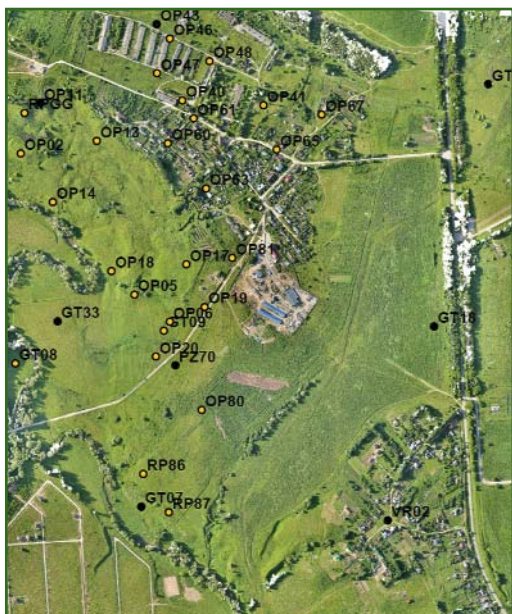
Рис. 7 Схема расположения опорных и контрольных точек для блока АФС БЛА «Птеро-Е5»
