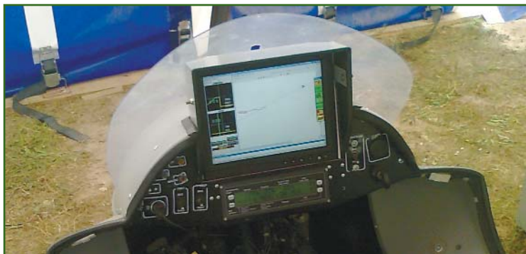
Рис. 4 Приборная панель мотодельтаплана с экраном монитора
