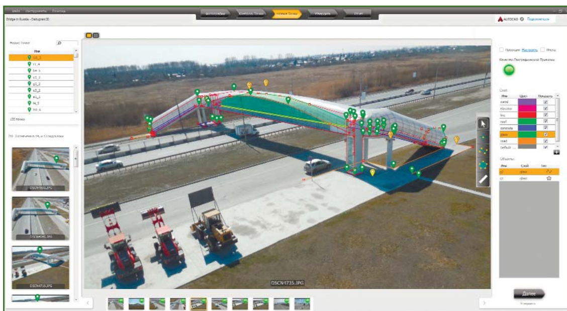
Рис. 5 Снимок пешеходного моста с опорными точками в ПО DatuGram3D (показаны желтым цветом)
