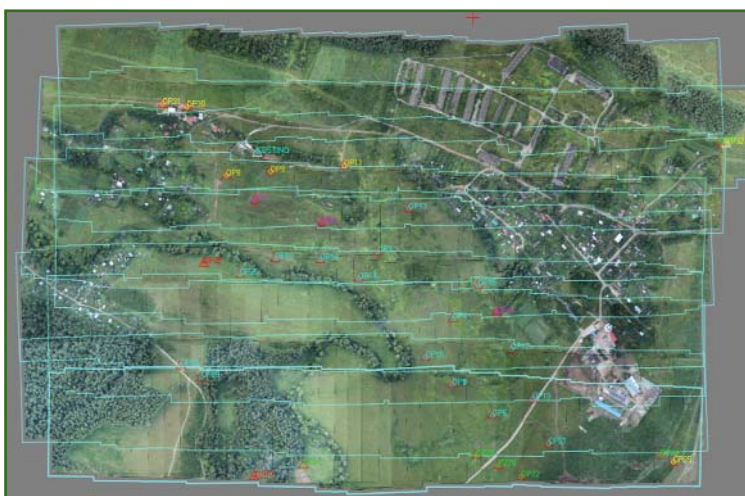
Рис. 2 Схема аэрофотосъемки БЛА «ПТЕРО-Е4» с высоты фотографирования 400 м
