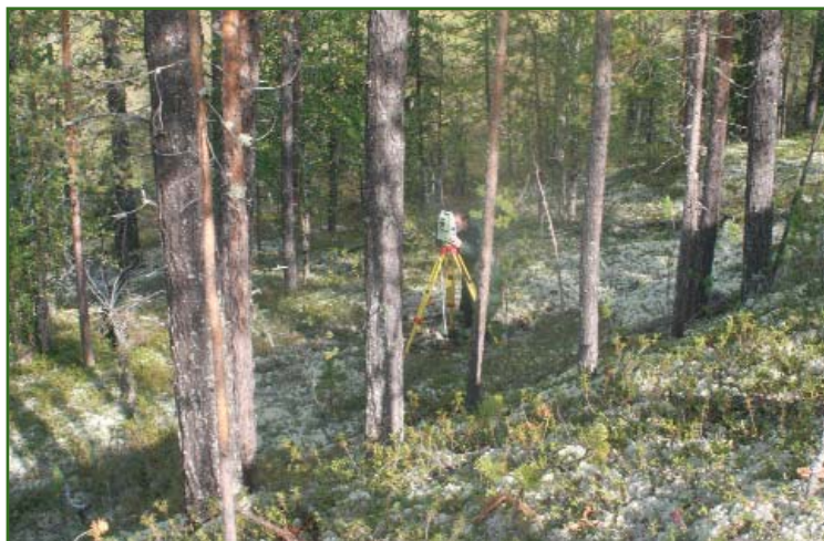
Рис. 5 Работа с тахеометром Leica FlexLine TS06
