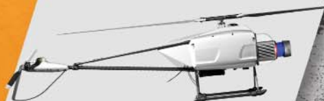
VUX ® -1 установлен на БПЛА Flying-Cam 3.0 SARAH
