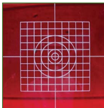
Рис. 1 Палетка прибора вертикального проектирования
