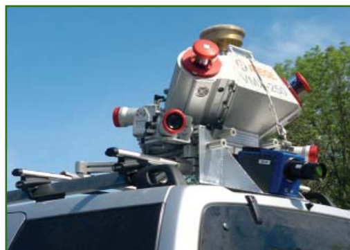
Рис. 3 Сканер, антенна приемника ГНСС и тепловизор, установленные на платформе
