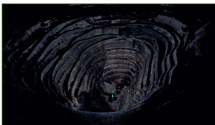
Рис. 3 Результаты лазерного сканирования бортов карьера «Удачный»
