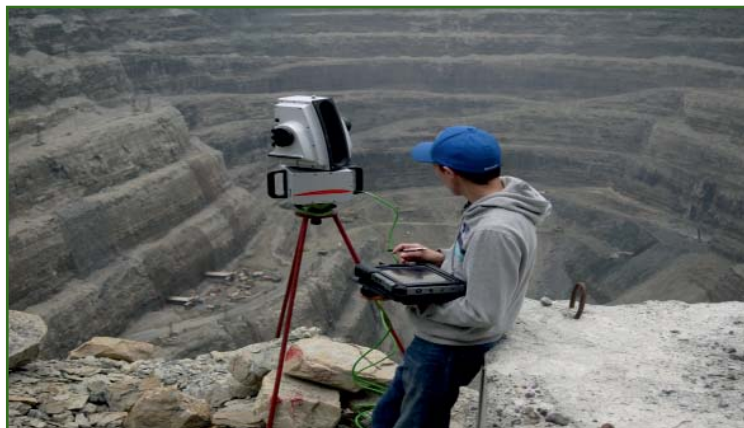
Рис. 2 Сканер Leica HDS 8800, установленный на штативе
