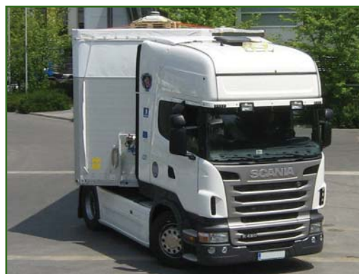
Рис. 1 Грузовой автомобиль с прицепом, на котором установлены антенны приемников ГНСС
