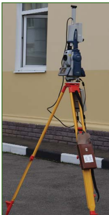
Рис. 1 Автоматическая система для гироскопического ориентирования на штативе
