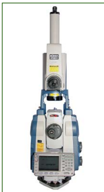
Рис. 2 Гироскопическая часть GYRO X, установленная на тахеометре
