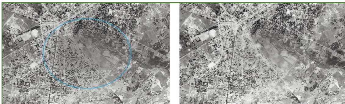
Рис. 3 Результат радиометрической коррекции изображения в программе UltraMap: до коррекции (слева); после коррекции (справа)
