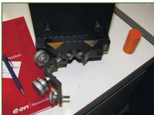
Рис. 5 Опора чувствительного датчика гидростатического нивелира
