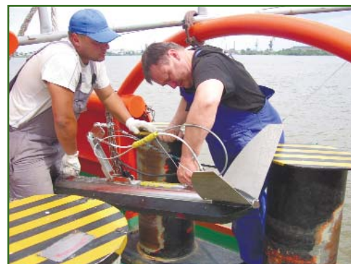
Рис. 4 Подготовка ГБО к работе
