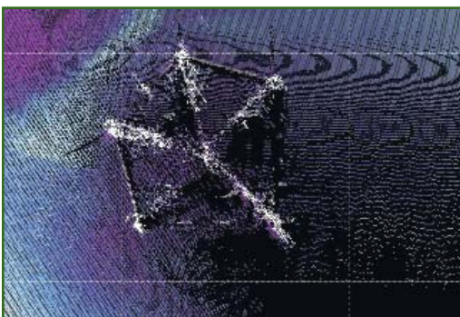
Рис. 1 ЦМР дна вокруг ТП, построенная по результатам промера. Черным цветом показаны пропуски в данных промера
