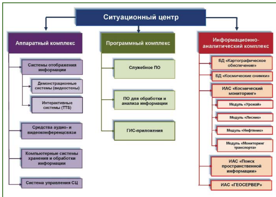
Рис. 1 Структура типового ситуационного центра, реализуемого компанией «Совзонд»
