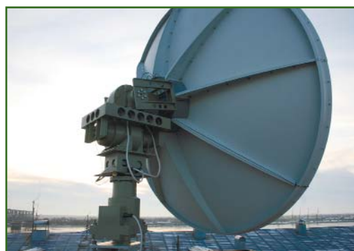
Рис. 3 Антенная система станции «УниСкан-36», установленная в Северном (Арктическом) федеральном университете
