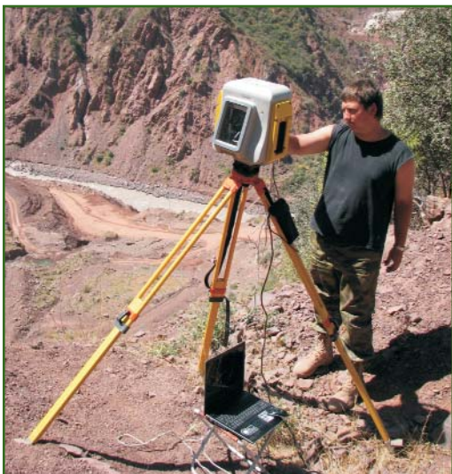
Рис. 4 Съемка сканером участка местности
