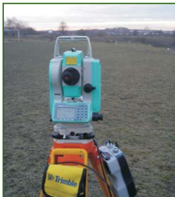
Рис. 2 Тахеометр Nikon NPR332, установленный на базе
