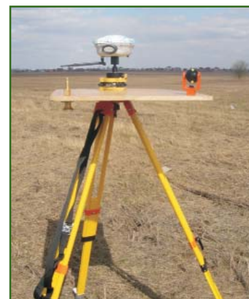
Рис. 4 Приемник Trimble R8GNSS со встроенным GSM-модемом и отражателем
