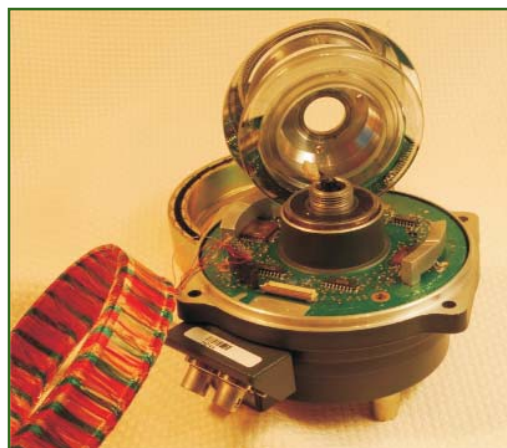
Рис. 4 Датчик угла вертикального и горизонтального кругов электронного тахеометра
