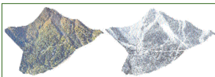
Рис. 1 Трехмерная модель рельефа верховий р. Мзымта, текстурированная ортофотоизображением: октябрь 2007 г. (слева); апрель 2007 г. (справа)
