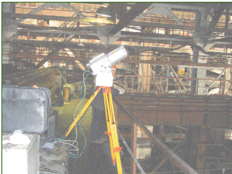
Рис. 5 Лазерный сканер Riegl LMS Z420i, установленный на порталном кране
