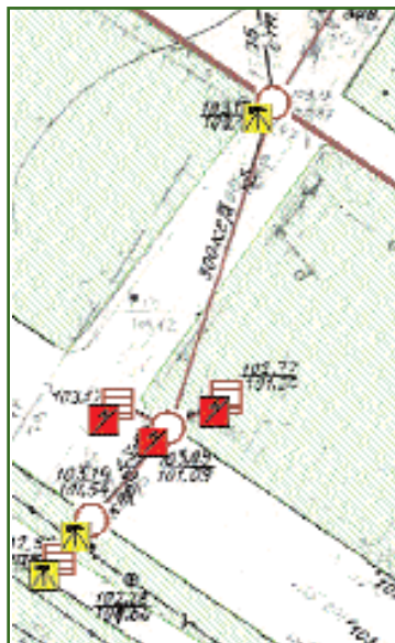
Рис. 3 Фрагмент дежурного плана города с нанесенными объектами (колодезь, дождеприемники)
