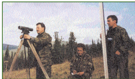
Рис. 1 Геометрическое нивелирование I класса (Верхне-Енисейское АГП)
