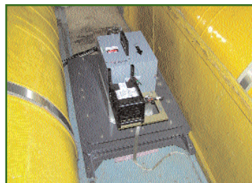
Рис. 1 Сканирующий блок, установленный на самолете
