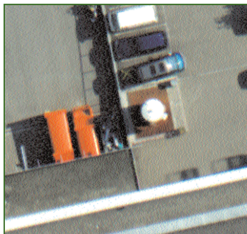
Рис. 10 Цветовые окантовки, заметные на изображении камеры 3-DAS
