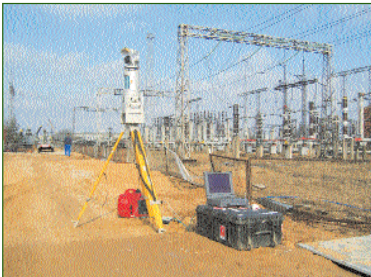
Рис. 2 Riegl LMS Z-420i с цифровой камерой Nikon D100 на объекте
