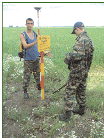
Рис. 2 Координирование планового положения подземных коммуникаций
