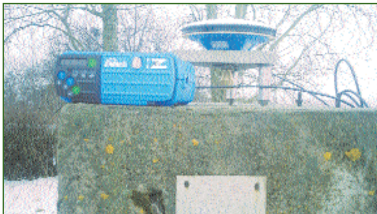
Рис. 2 Измерения на пункте полигона с помощью спутникового геодезического приемника Z-Xtreme
