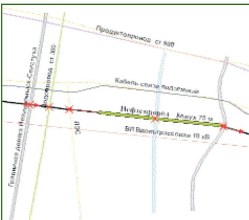
Рис. 3 Информация о пересечении трассы нефтепровода
