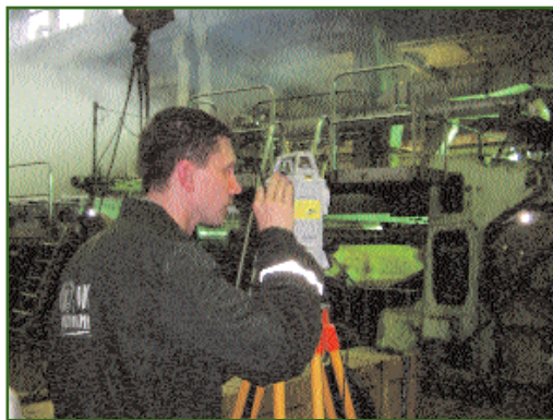
Рис. 3 Измерение координат характерных точек цилиндров
