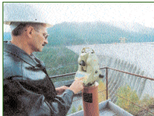
Рис. 2 Принудительное центрирование электронного тахеометра на знаке
