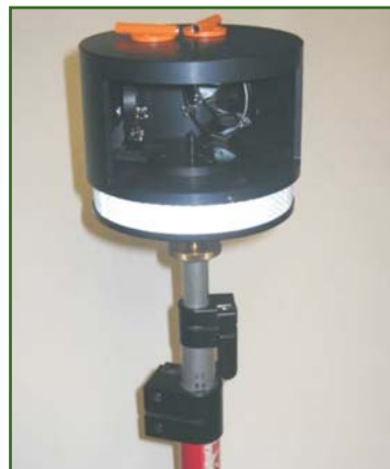
Рис. 5 Ортогональный экер с корпусом и диоптрами
