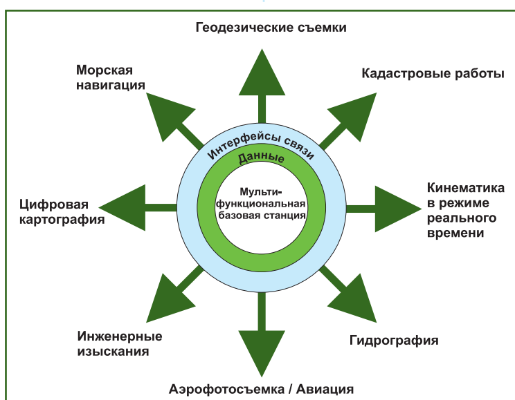
Рис. 1 Основной принцип действия базовой станции SAPOS
