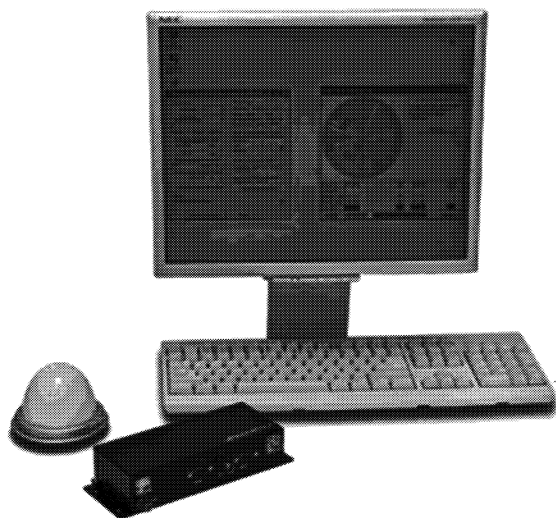
Рис. 12.3. Спутниковая базовая станция СБС-161
