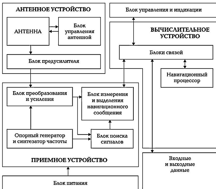
Рис. 12.1. Структурная схема приемника спутниковых сигналов
