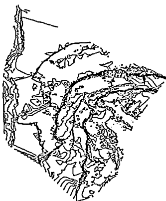
Рис. 12.21. Построение горизонталей по модели рельефа
