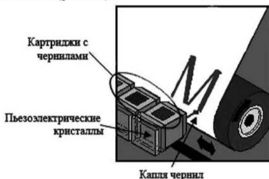
Рис. 20. Схема работы струйного принтера
