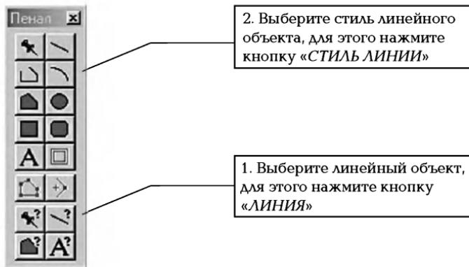
Рис. 34. Цифрование линейного объекта
