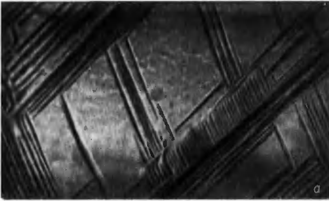
Рис. 25. Микрофотографии монокристалла \alpha -урана после удлинения ( \times 200 ):
