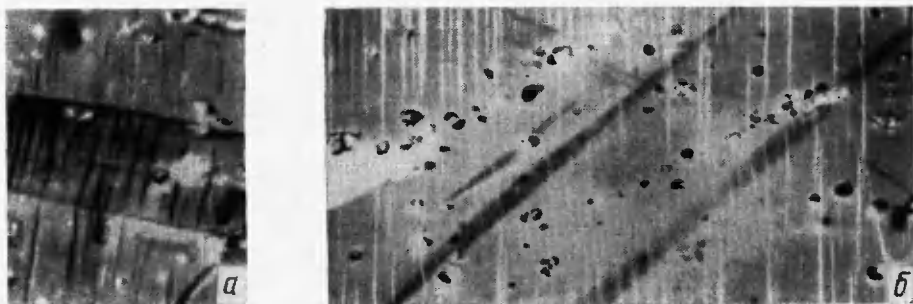
Рис. 31. Полосы излома в уране:
