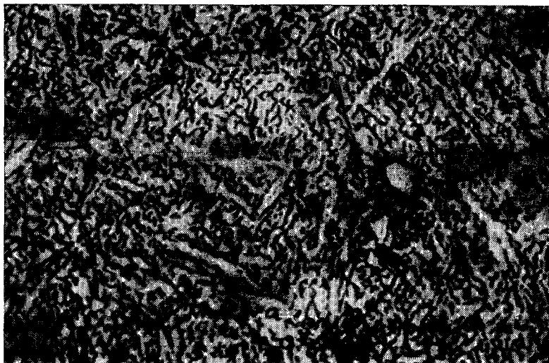
Рис. 83. Топкая игольчатая структура закаленного в воду сплава урана с 2% циркония. Сплав имеет высокую коррозионную стойкость при травлении. Твердость сплава 403 кг/мм 2 (по Виккерсу). \times 1000 .
