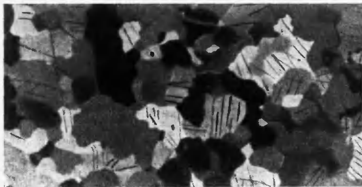
Рис. 35. Структура рекристаллизованного \alpha -урана. Образец был выдавлен в \gamma -фазе при 1050^\circ\text{C} (коэффициент вытяжки 13,3) и охлаждался на воздухе, вновь нагрет до 720^\circ\text{C} и после выдержки в течение 15 мин закален в воду. Рекристаллизация 30 мин при 640^\circ\text{C} и закалка в воду. Электролитическая полировка. Поляризованный свет. \times 100 .
