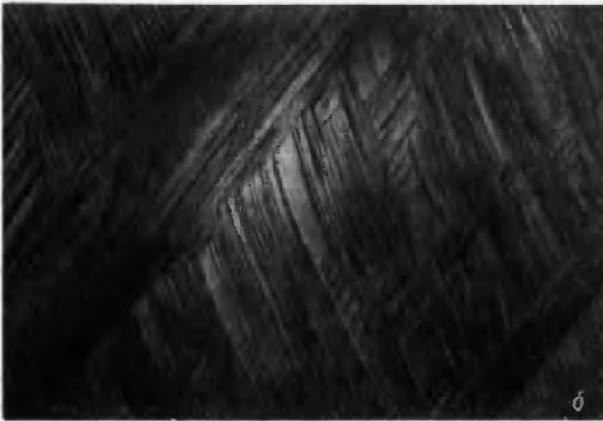
Рис. 26. Рентгенограммы обратной съемки монокристалла \alpha -урана после деформации растяжением:
