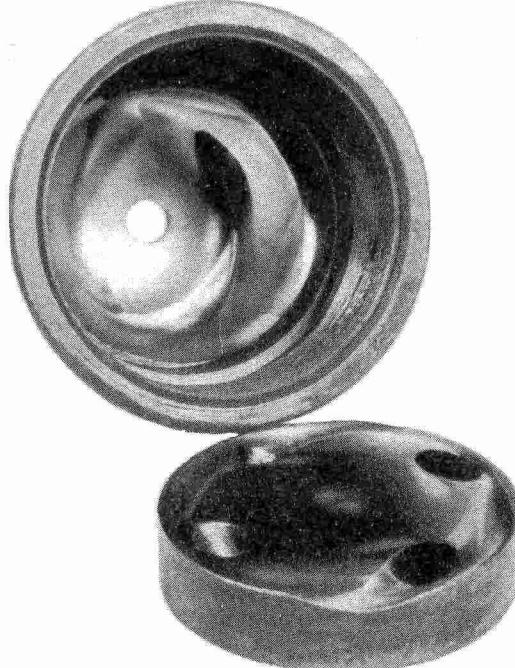
На снимке: завихритель и корпус кавитатора. В металле видны впадины с плавными краями — следы кавитационного «вырыва».
