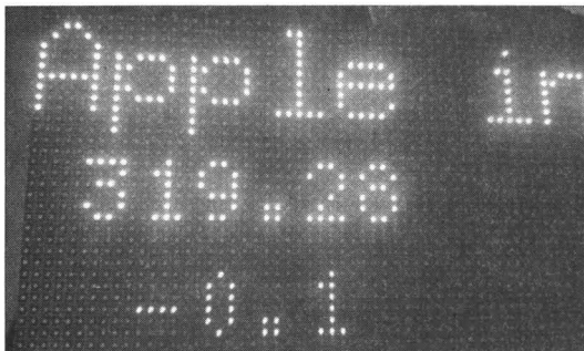
Рис. 6.19. Вывод на RGB-матрицу 64×32 текущих котировок акций Apple
