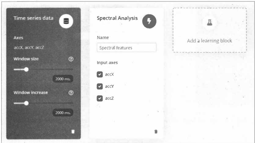
Рис. 6.86. Выполнение спектрального анализа сигнала и извлечение данных о его частоте и спектральной мощности
