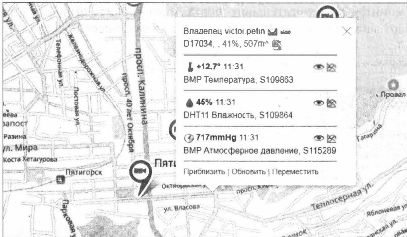
Рис. 5.34. Отображение данных, полученных от устройства, на карте сервиса «Народный мониторинг»
