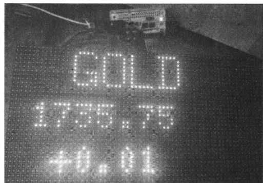
Рис. 6.20. Вывод на RGB-матрицу 64×32 текущих котировок золота
