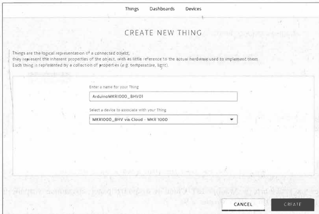
Рис. 5.7. Выбор названия и платы для устройства в Arduino IoT Cloud
