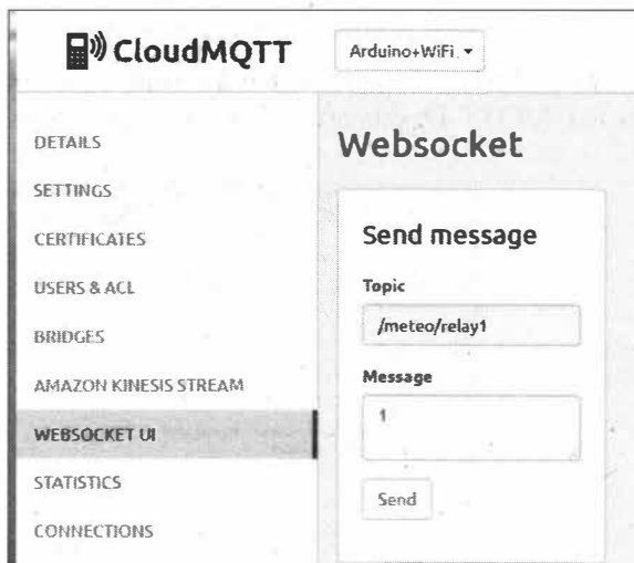
Рис. 4.6. Отправка команд управления из профиля cloudmqtt.com
