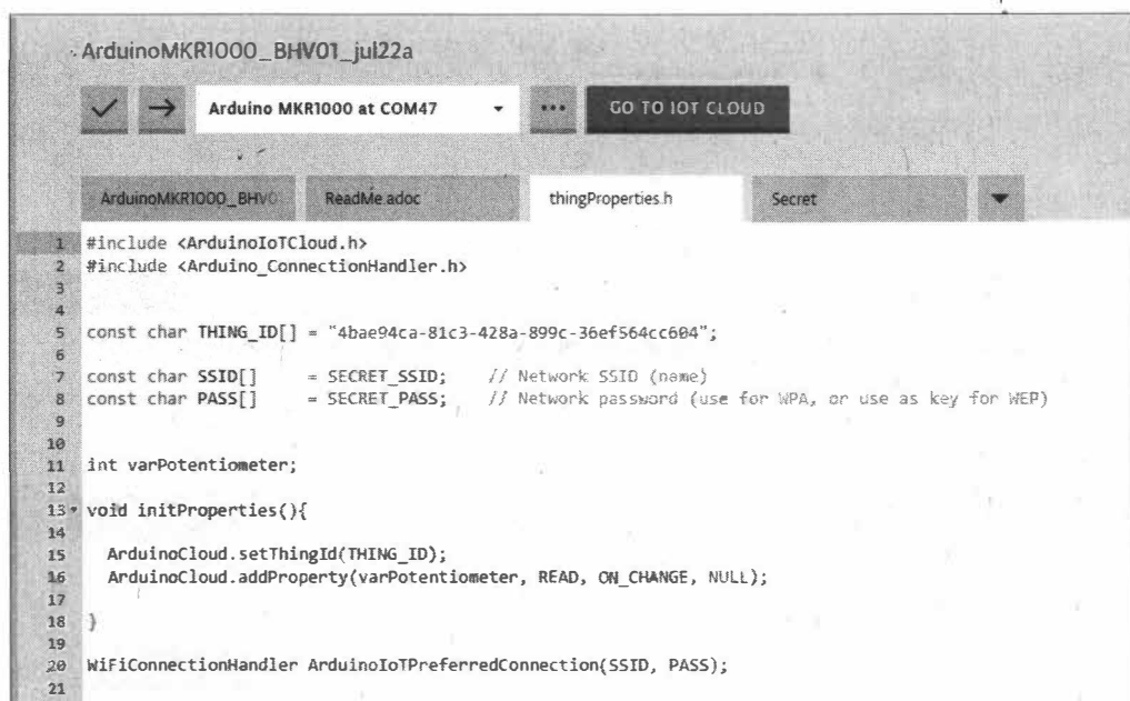
Рис. 5.13. Вкладка thingProperties.h с заготовкой кода
