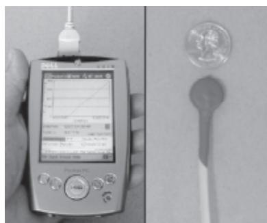
исследований в этой области, сообщила о начале производства устройства температурного мониторинга бетонного раствора - COMMAND Center™ (Concrete Materials Management Device). Устройство разработано на основе микросхемы Thermochron iButton (производство MAXIM-DALLAS), которая позволяет следить за температурой и другими характеристиками бетонного раствора до его полной готовности.
