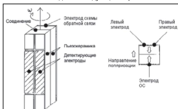
Рис. 2. Принцип действия пьезогироскопа.
