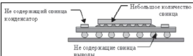
Рис. 1. Корпус типа Flip Chip Ball Grid Array.
