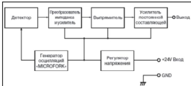
Рис. 6. Принципиальная блок-схема датчика серии РКЕ.
