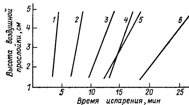
Рис. 23. Влияние высоты воздушной прослойки над растворителем на продолжительность испарения 90% растворителя: 1 — ацетон; 2 — гептан; 3 — толуол; 4 — изопропиловый спирт; 5 — МИБК; 6 — бутилацетат.
