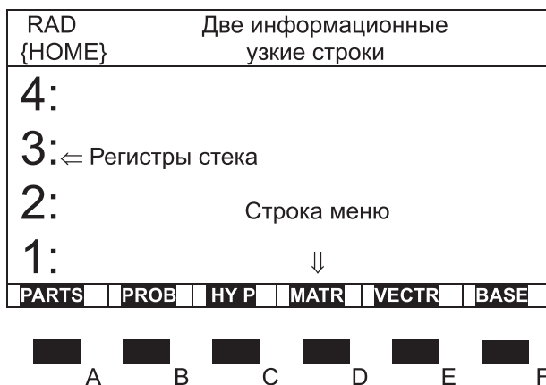
Рис. 5.2. Блок дисплея и функциональных клавиш калькулятора HP-48
