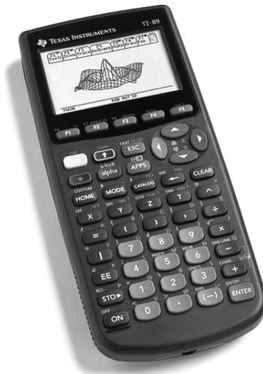
Рис. 1.10. Внешний вид научного графического микрокалькулятора TI-89 с возможностью выполнения символьных операций
