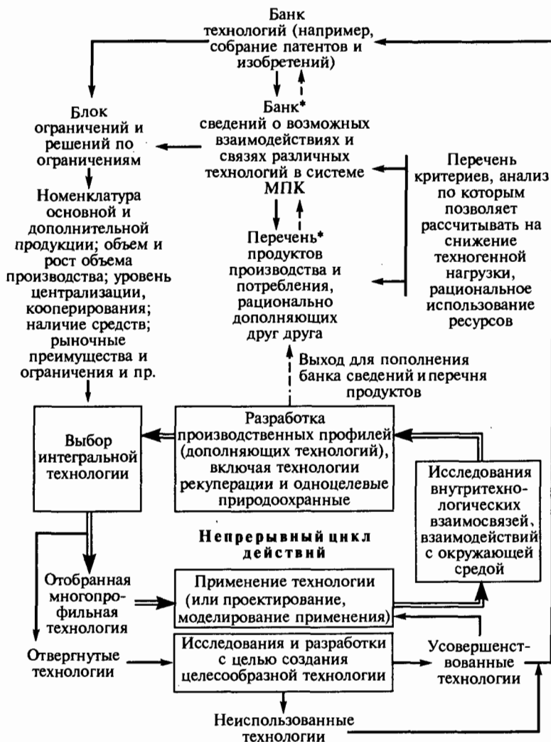
Рис. 1.2. Блок-схема выбора и принятия проектных решений, основанных на стратегии создания малоотходной технологии
