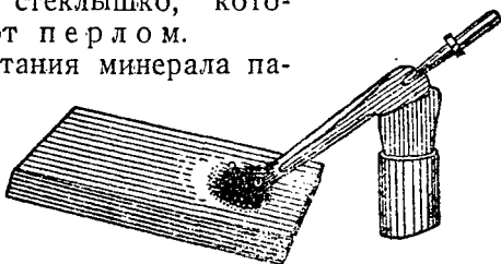
Фиг. 17. Испытание минерала перед паяльной трубкой на куске древесного угля
