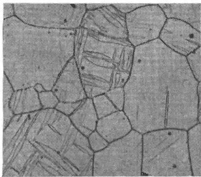
Рис. 97. Чистый магний после травления реактивом 2, 2 мин, \times 200
