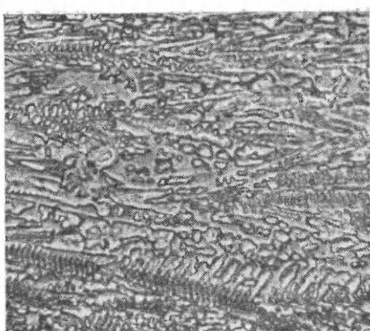
Рис. 52. Стеллит (2,20% C; 1,75% Mn; 29,5% Cr; 18,0% W; 44,0% Co) после травления реактивом 74a, 45 с, X1500
