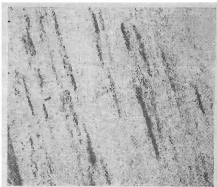
Рис. 64. Распределение включений в томасовской стали после травления реактивом 1, X 8
