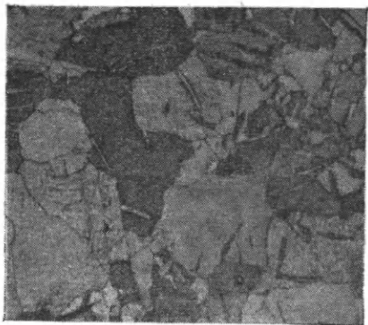
Рис. 83. Чистый кадмий после травления 20%-ным спиртовым раствором азотной кислоты, 20 с, \times 300
