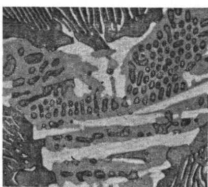
Рис. 63. Тройная фосфидная эвтектика (стеадит) в половинчатом чугуне после травления реактивами 19a—г . \times 700
