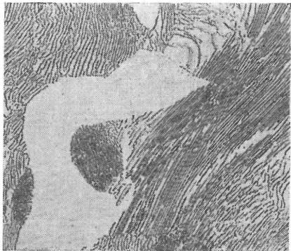
Рис. 30. Участки перлита в стали РД7 после травления реактивом 20, 15 с, \times 300
