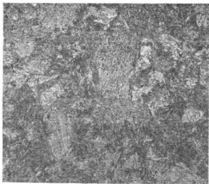
Рис. 40. Мартенсит, расположенный на границах зерен аустенита, после травления, реактивом 50, 4 мин, \times 300
