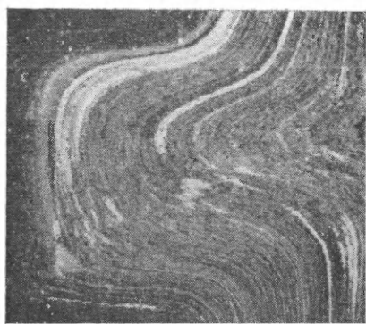
Рис. 16. Распределение фосфора. Травление реактивом 24, 30 с, \times 5
