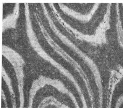
Рис. 20. Фосфорный отпечаток дамасской стали после травления реактивом 31 [37], \times 3
