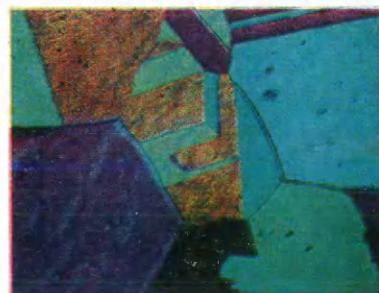
Рис. IV. Цветное травление марганцовистого аустенита в марганцевой стали (1.06% C; 13.6% Mn) тиосульфатом натрия (III), 20с, \times 250
