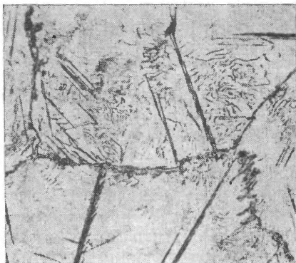
Рис. 36. Вторичный и входящий в состав перлита цементит после травления реактивом 40 при 40° С, 10 мин, \times 500
