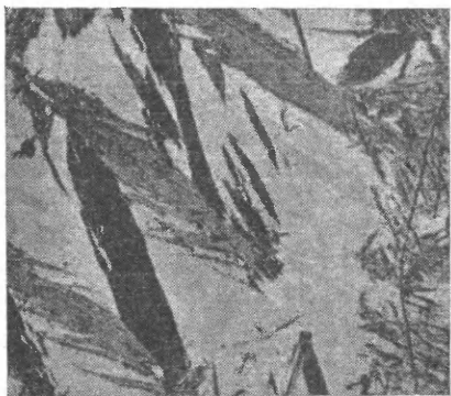
Рис. 38. Углеродистая сталь (1,67% С; 0,14% Si; 0,45% Mn; 0,017% P; 0,02% S): закалка с 1125° С в воде + отпуск при 210° С, 8 ч. \xi -фаза после травления реактивом 40 при 19° С, 39 ч [36], \times 600
