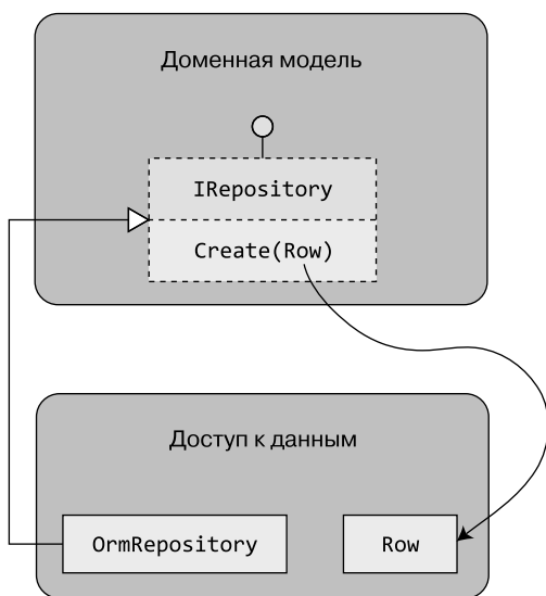
Рис. 16.5. Типичный цикл доступа к данным. Доменная модель определяет интерфейс доступа к данным IRepository. Члены определяются с возвращаемыми типами или параметрами, взятыми из уровня доступа к данным. Например, класс Row может быть определен с помощью объектно-реляционного отображения (ORM). Так, доменная модель будет зависеть от уровня доступа к данным. С другой стороны, класс OrmRepository — это основанная на ORM реализация интерфейса IRepository, которая не может реализовать интерфейс без ссылки на него. Поэтому уровень доступа к данным зависит и от доменной модели. Иначе говоря, зависимости образуют цикл
