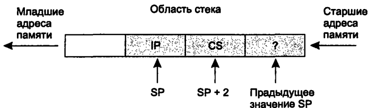
Рис. 6.7. Содержимое стека после вызова дальней процедуры
