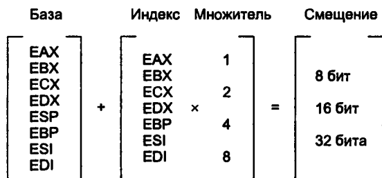
Рис. 3.11. Схема вычисления эффективного адреса (EA)
