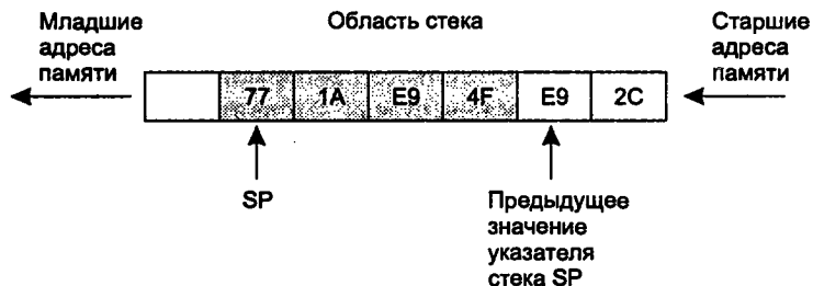
Рис. 6.3. Размещение двойного слова в стеке
