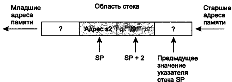
Рис. 6.5. Содержимое стека после помещения данных программы
