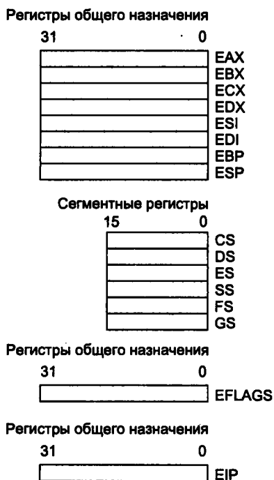
Рис. 3.6. Базовые регистры процессора Intel Pentium
