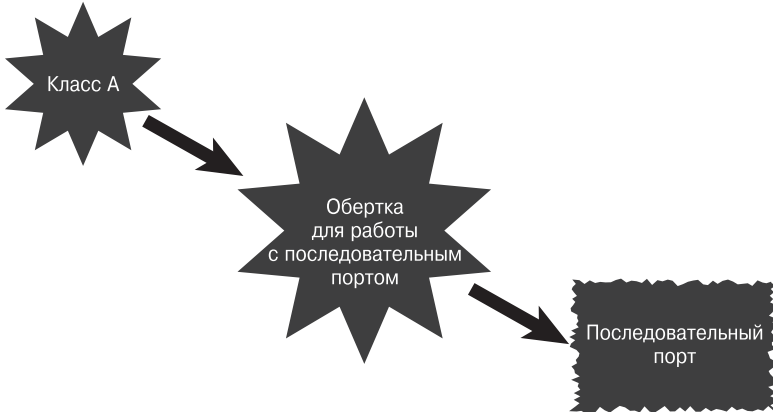
Рис. 5.5. Обертка для работы с последовательным портом
